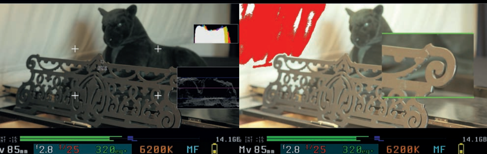
Dank Luminanz-Wellenform, RGB-Histogramm und Spotmeter sind perfekte Belichtung und Weißabgleich kein Hexenwerk mehr (links). Die Zebra-Darstellung ist schnell und präzise; die Fokusslupe Magic Zoom funktioniert auch während der Videoaufnahme.
