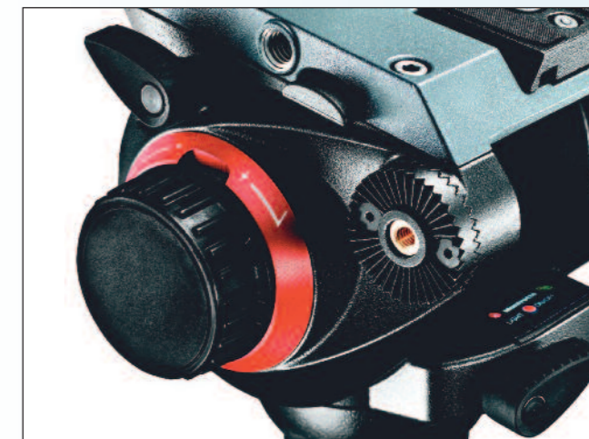
Profianspruch: Die Friktion lässt sich mit griffigen Drehstellern fein einstellen; die Schwenkarmrosetten sind austauschbar.
