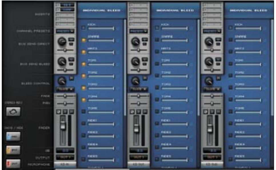
*Das Übersprechen jedes Instrumentes lässt sich bei SD2 an jedem Mikrofonkanal separat regeln*
