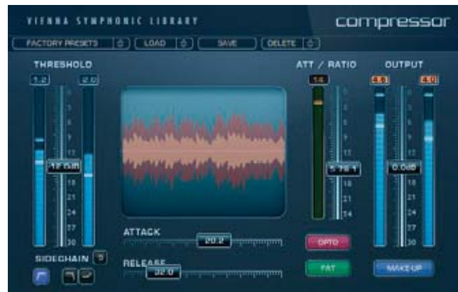
Der Compressor visualisiert sein Regelverhalten anhand einer Wellenform-Darstellung.
