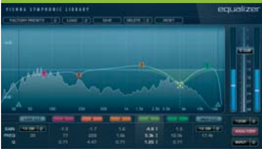
Der Equalizer: Mit fünf parametrischen Bändern, Hoch- und Tiefpaß-Filter und Spectrum-Analyser ist der Vienna Suite Equalizer hervorragend ausgestattet.
