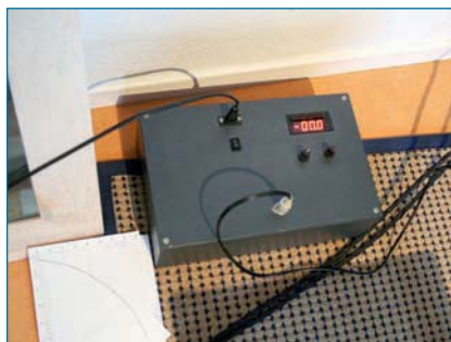
Das selbst konstruierte Steuergerät bestimmt die Geschwindigkeit, mit der jede Taste exakt gleich stark angeschlagen wird.
